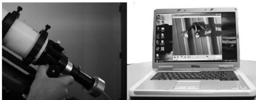
Figura 8. Muovendo gradualmente il focheggiatore si può ottenere un'immagine perfettamente messa a fuoco sul PC.
