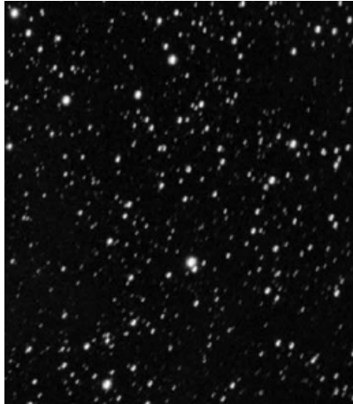
Figura 4. Tipica rotazione di campo nelle lunghe esposizioni guidate attraverso una montatura azimutale, o una montatura equatoriale con allineamento al polo approssimativo.
